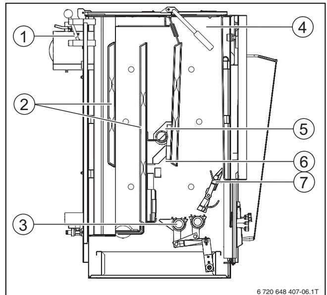
Рис. 2 Котёл в разрезе, здесь тип 24
