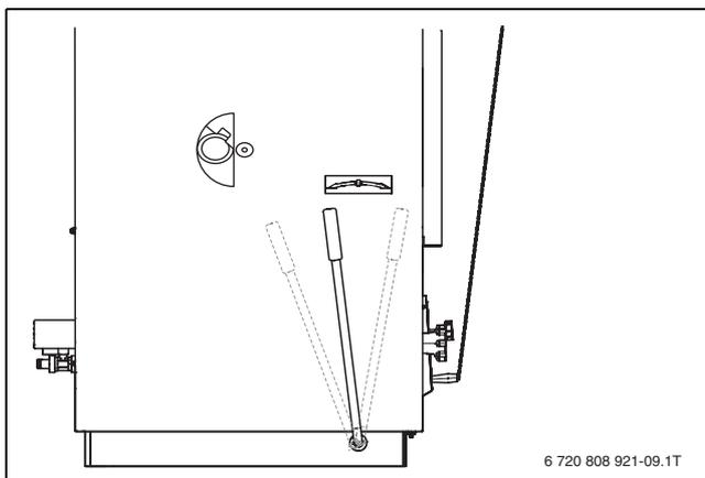
Рис. 14 Рычаг встряхивания колосниковой решётки в рабочем положении
