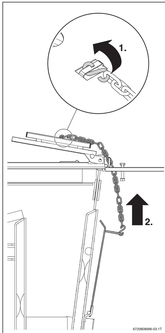
Рис. 18 Выньте взрывозащитный клапан
