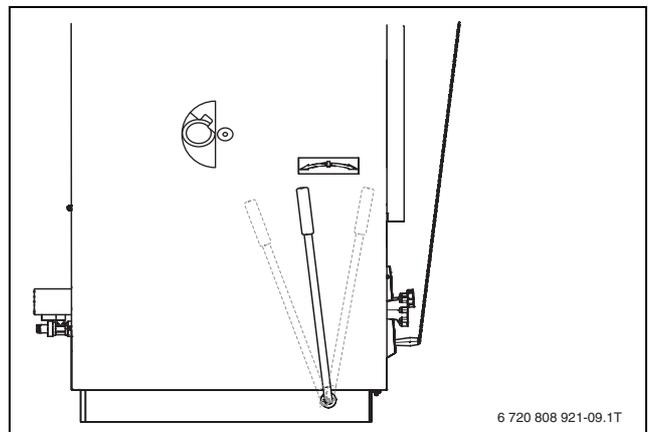
Рис. 10 Рычаг встряхивания колосниковой решётки в рабочем положении
