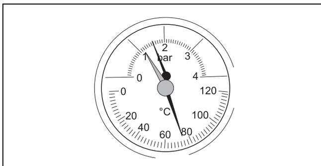
Рис. 17 Термоманометр
