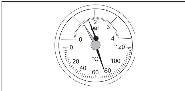
Рис. 22 Термоманометр
