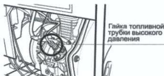
Гайка топливной трубки высокого давления
