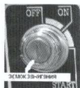
Рис.3. Замок зажигания
