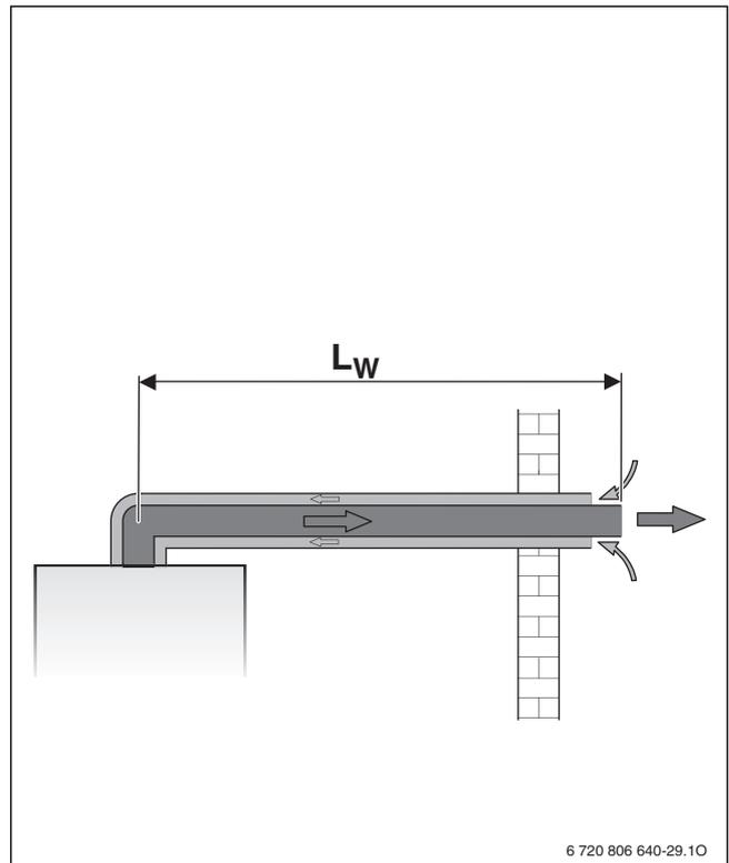
Рис. 8 Горизонтальный отвод дымовых газов по C<sub>12</sub> с концентрической трубой
