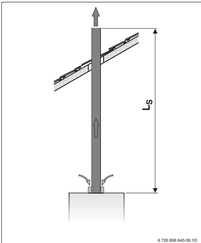
Рис. 7 Вертикальный отвод дымовых газов по B<sub>22</sub>
