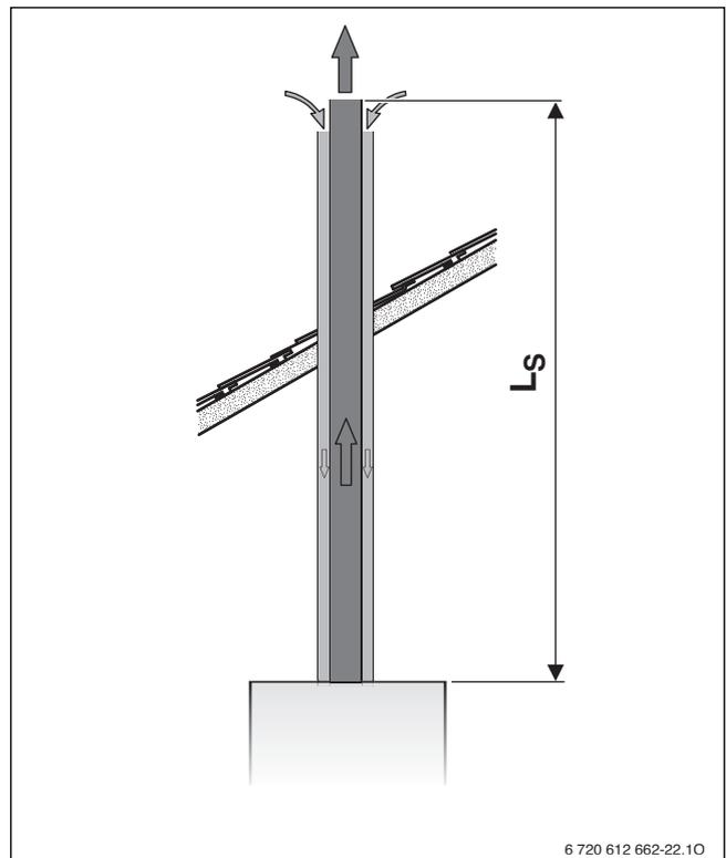
Рис. 9 Вертикальный отвод дымовых газов по C<sub>32</sub> с концентрической трубой
