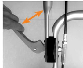
4. Отрегулируйте натяжение, поворачивая стопорную гайку (4) с помощью подходящего гаечного ключа.
