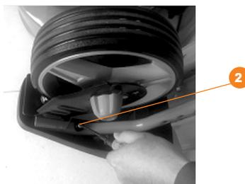
2. Установите поворотное колесо (3) на корпус газонокосилки с помощью 3-х болтов и гаек(4).
