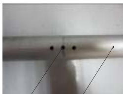
Штанга Три регулировочных отверстия на штанге рис. 2.2
