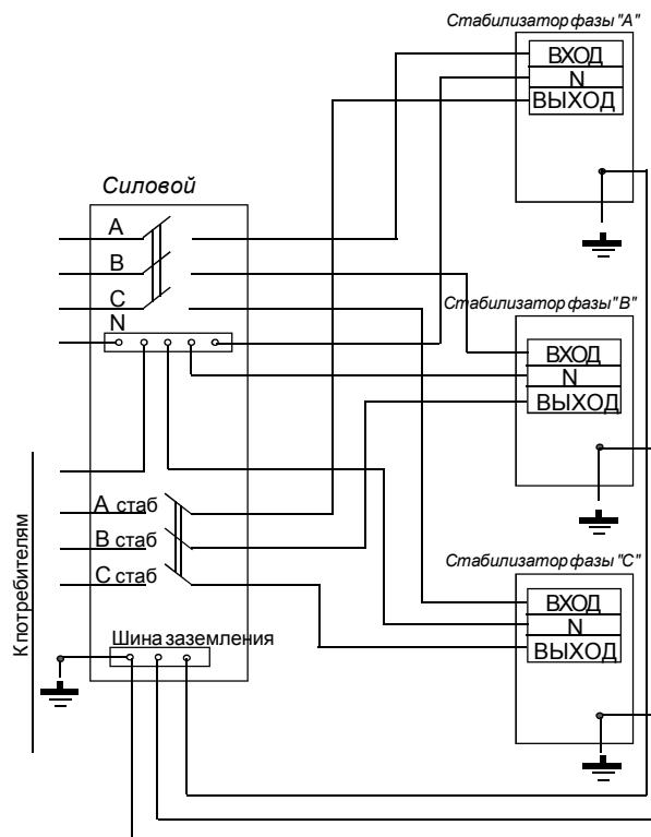
Рисунок 4 - Схема подключения стабилизатора в трехфазной сети
