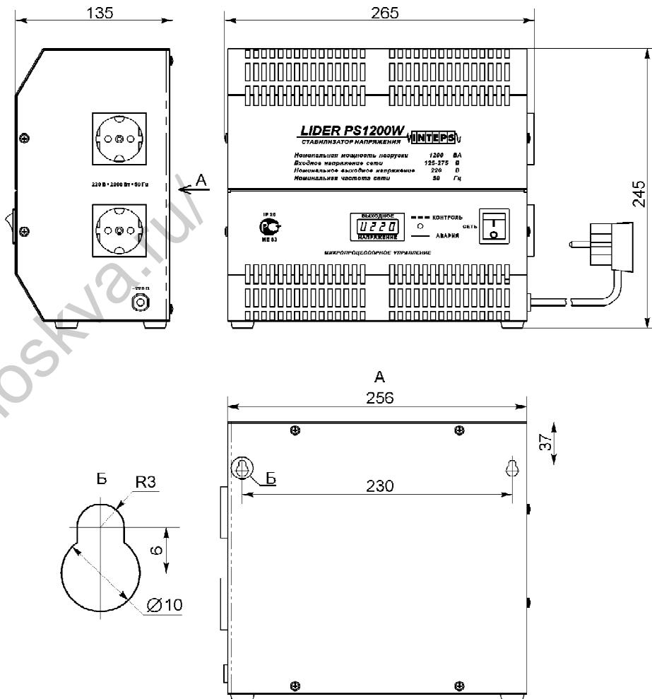
Габаритные и установочные размеры стабилизатора **LIDER PS1200W-50**
