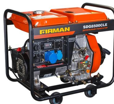
Дизельный генератор Firman SDG8500TCLE это трехфазный дизельный генератор SDG линейки, максимальной мощностью до 6,6 кВт и напряжением 380В. На фронтальной стороне присутствуют розетки с заземлением. Firman SDG8500TCLE укомплектован 4-х тактным, одноцилиндровым дизелем, мощностью 10,5 л.с., с прямым впрыском и системой воздушного охлаждения. Пуск двигателя осуществляется при помощи ручной или электрической системы запуска. Присутствует система защиты от низкого уровня масла.
