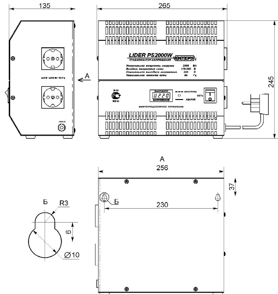
Габаритные и установочные размеры стабилизаторов напряжения переменного тока:
