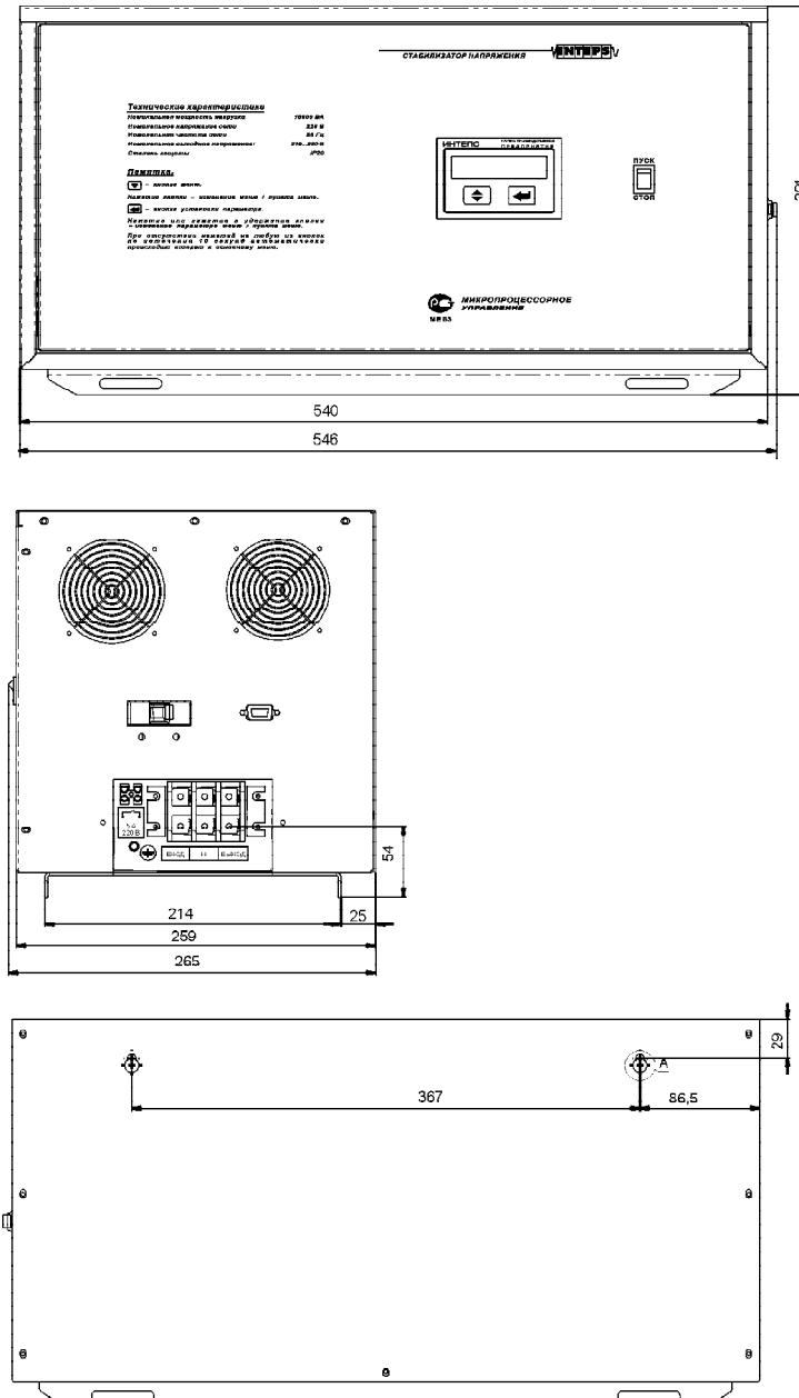
Габаритные и установочные размеры стабилизатора напряжения переменного тока **LIDER PS7500SQ-40**
