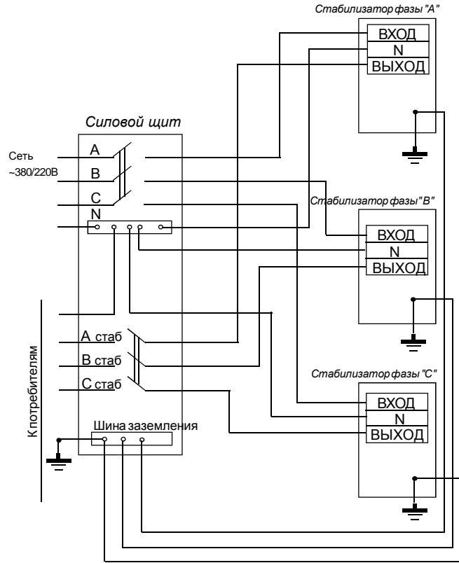
Рисунок 4 - Схема подключения стабилизатора в трехфазной сети
