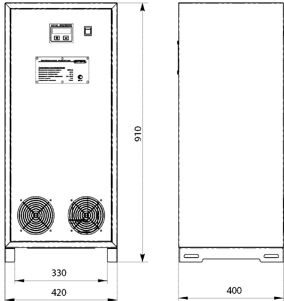
Габаритные и установочные размеры стабилизаторов напряжения переменного тока **LIDER PS12000SQ-I-40**
