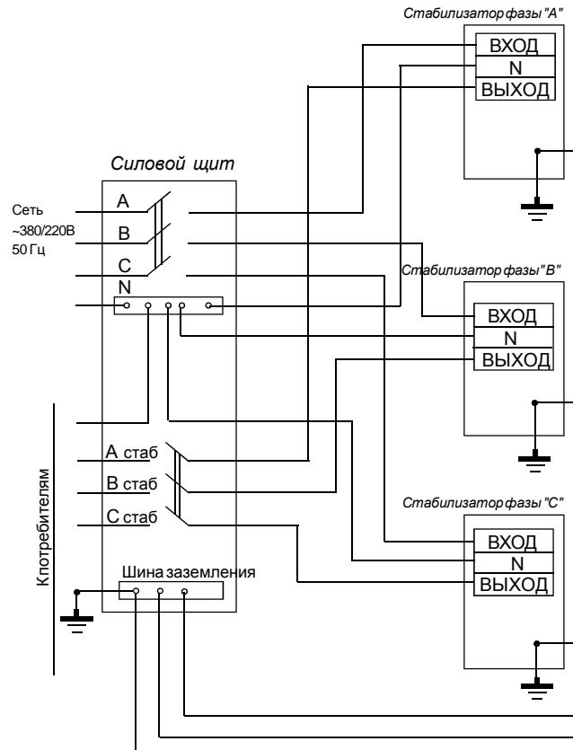
Рисунок 3 - Схема подключения стабилизаторов к трехфазной сети
