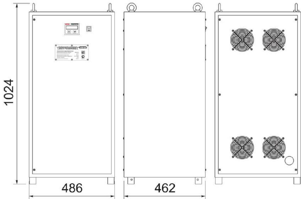
Габаритные и установочные размеры стабилизаторов напряжения
