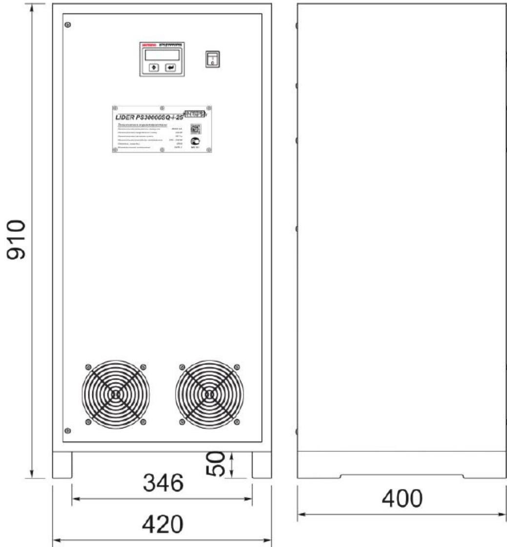
Габаритные и установочные размеры стабилизаторов напряжения
