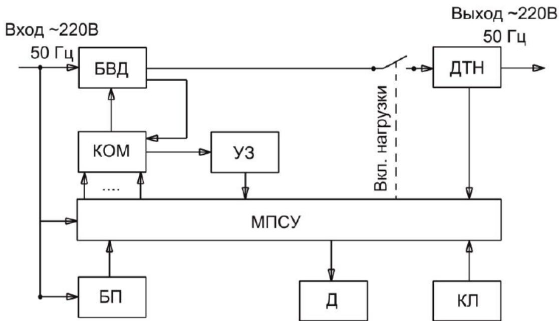
БВД – блок вольтодобавки; КОМ – коммутатор; МПСУ – микропроцессорная система управления; БП – блок питания; УЗ – устройство защиты; Д – дисплей цифровой; ДТН – датчик тока нагрузки; КЛ – клавиатура
