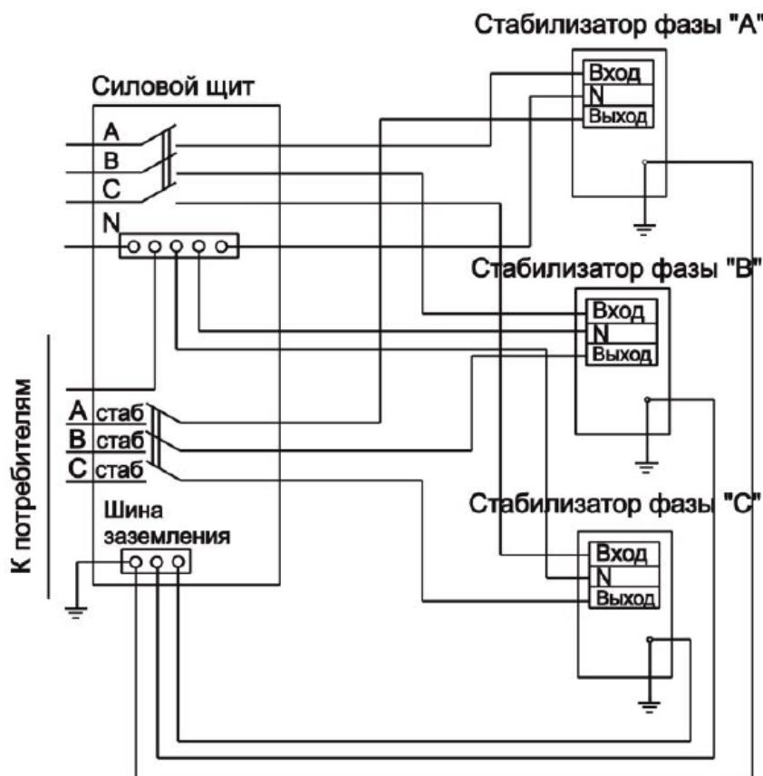
Рисунок 3 – Схема подключения стабилизаторов к трёхфазной сети
