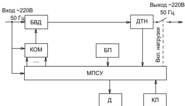
БВД – блок вольтдобавки; КОМ – коммутатор; МПСУ – микропроцессорная система управления; БП – блок питания; Д – дисплей цифровой; ДТН – датчик тока нагрузки; КЛ – клавиатура.
